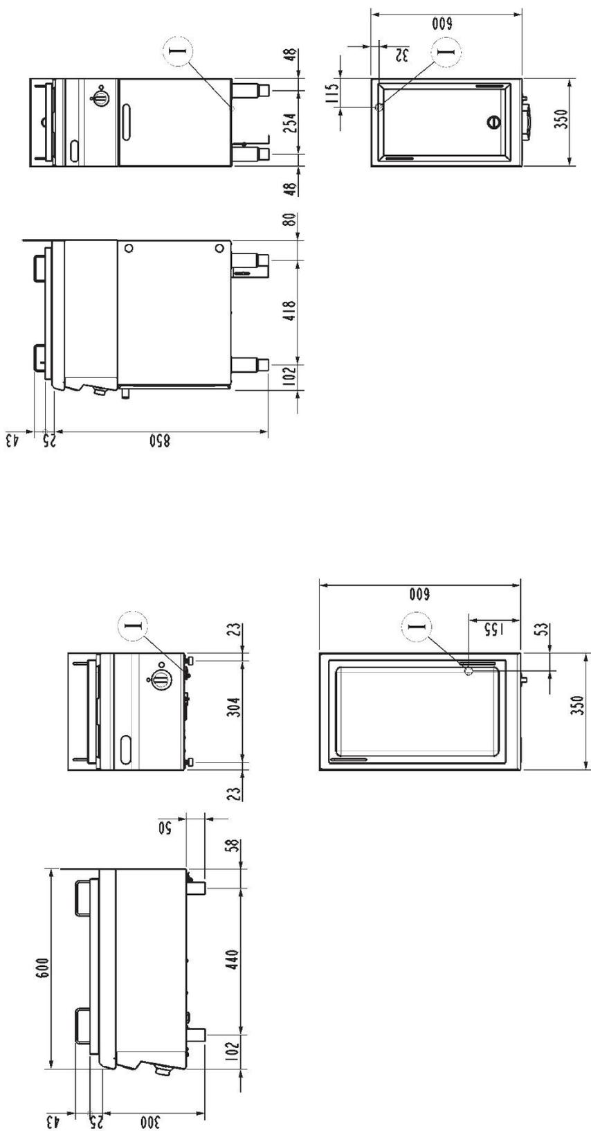
I = Entrata cavo elettrico | Power supply cable inlet | Netzkabeleingang | Вход электропровода | Entrée câble électrique | Entrada cable eléctrico.
