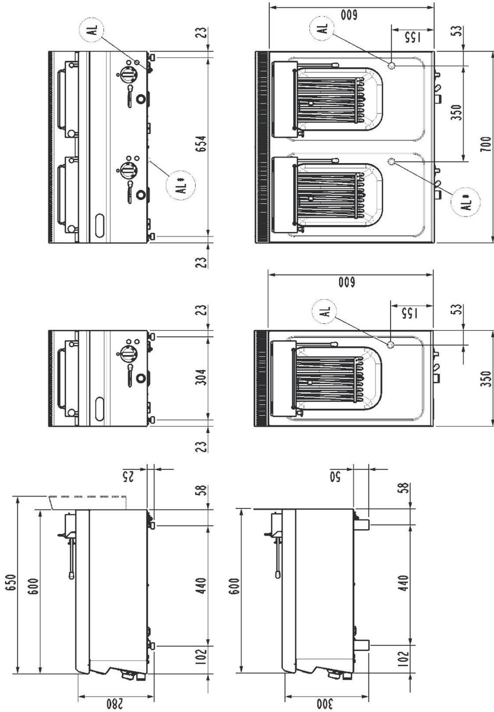
Al = Entrata cavo elettrico | Power supply cable inlet | Netzkabeleingang | Вход электропровода | Entrée câble électrique | Entrada cable de alimentación.
