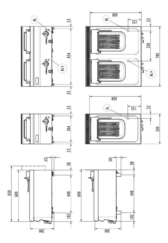
AI\* = Entrata 2° cavo elettrico | 2nd Power supply cable inlet | 2° Netzkabeleingang | 2° Bxoд электропровода | Entrée 2° câble électrique | Entrada 2° cable de alimentación. Al = Entrata cavo elettrico | Power supply cable inlet | Netzkabeleingang | Bxoд электропровода | Entrée cable électrique | Entrada cable de alimentación.
