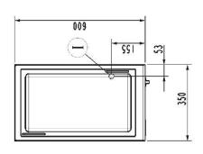
I = Entrata cavo elettrico | Power supply cable inlet | Netzkabeleingang | Bxog электропровода | Entrée cáble électrique | Entrada cable eléctrico.
