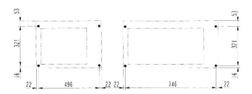
Schema di foratura parete in calcestruzzo per fissaggio staffe Schema für Betonwandbohrungen zur Befestigung der Wandhalterungen Diagram for drilling cement walls for the fastening of brackets Schéma de perçage de la paroi en béton pour fixer les étriers Esquema de perforación de la pared de hormigón para fijación soportes
